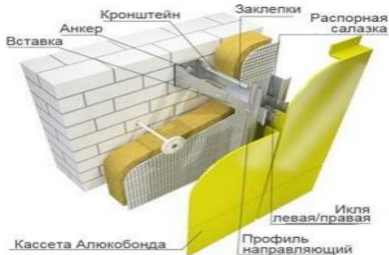
Схема монтажа «Распорных салазок»
